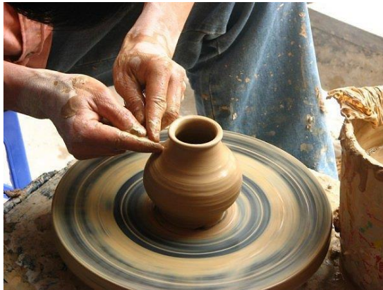
Hình 10: Công đoạn tạo hình gốm từ đất sét trắng và cát
