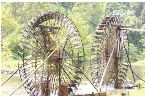
Hình 6: Bánh xe nước quay cung cấp nước cho tưới tiêu nhờ nguồn năng lượng dòng chảy của nước
